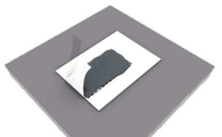
9. Nach ausreichender Reaktionszeit abscherend ziehen, Zugkraft erhöhen
